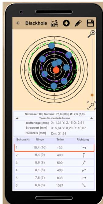
Zur Auswertung müssen vorab in der App das Kaliber und die erlaubte Schusszahl pro Scheibe eingegeben werden. Die Kamera wird dann über die Scheibe gehalten und die Software wertet die erkannten Treffer aus und zeigt die Ringe auf 1/10 an.
